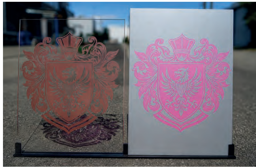
Links: Maskierflüssigkeit für Ätzanwendung auf Glas; rechts: Maskierflüssigkeit für mechanische Bearbeitung auf Metall
